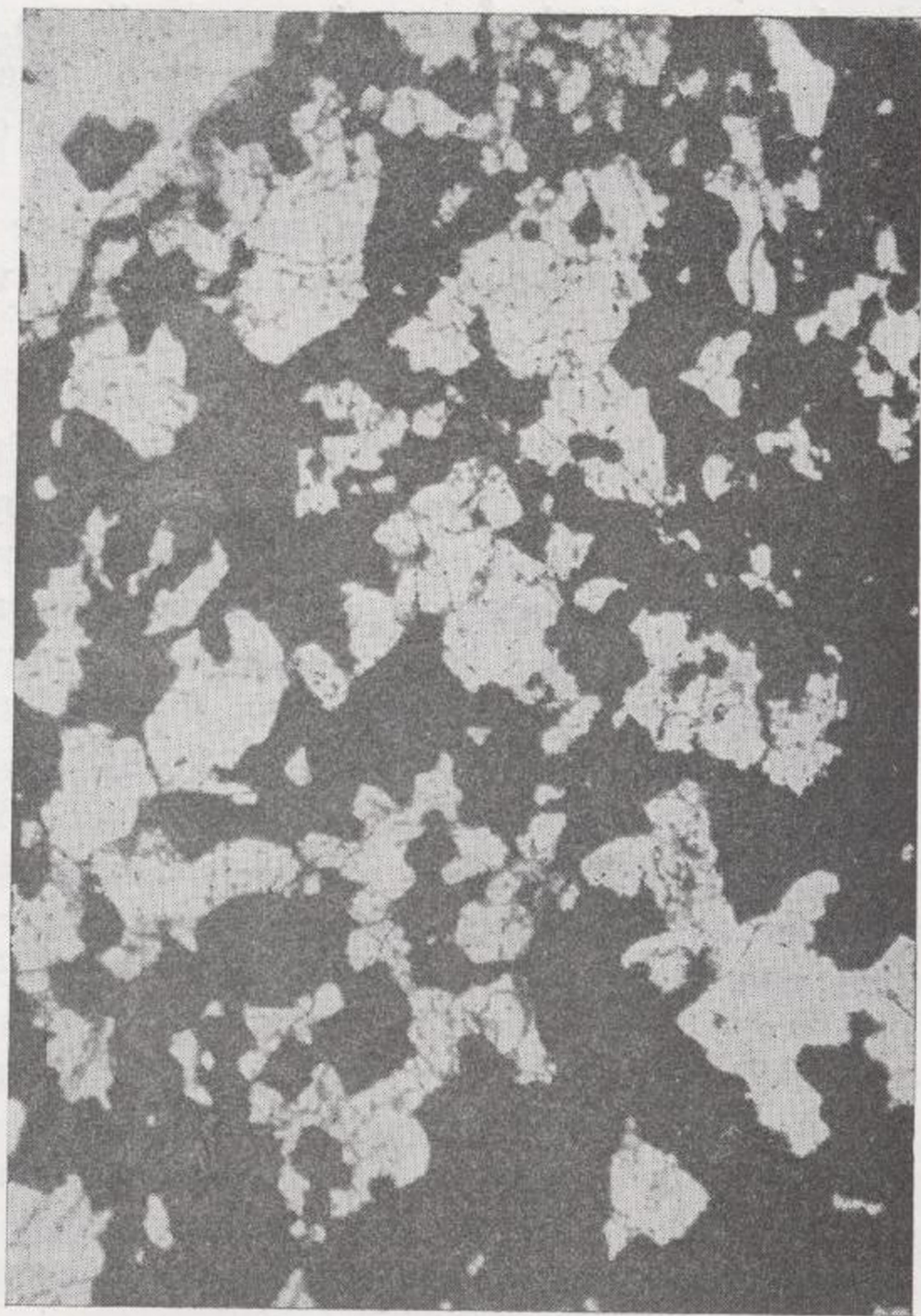
Microfot. 2.—JT-33, 37,20 m. Magnetita poiquilítica con inclusiones de dolomita. Nícoles paralelos, 135 \times ,
