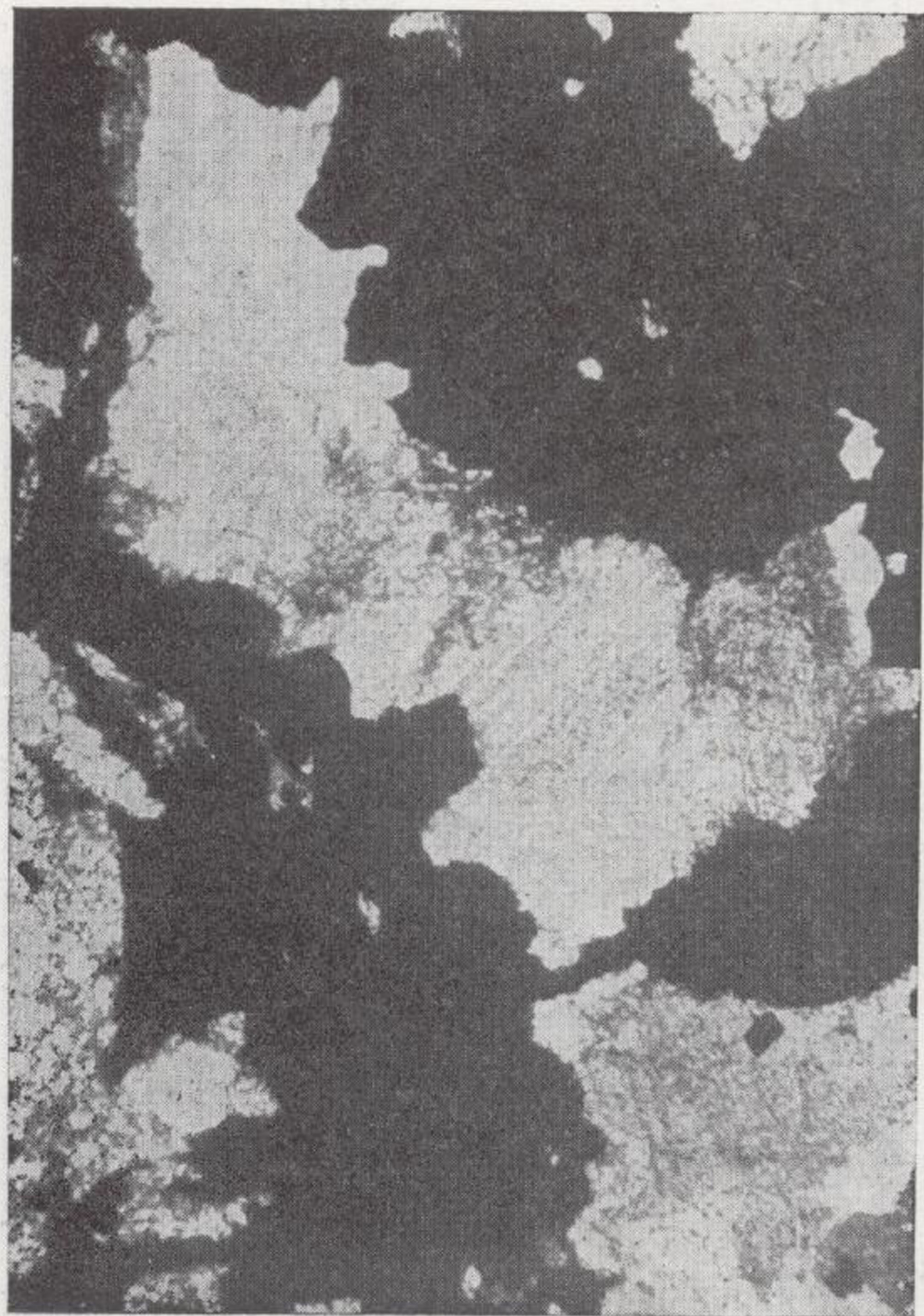
Microfot. 3.—JT-33, 37,20 m. Magnetita incluyendo carbonato de magnesio. Nícoles cruzados, 135 ×.
