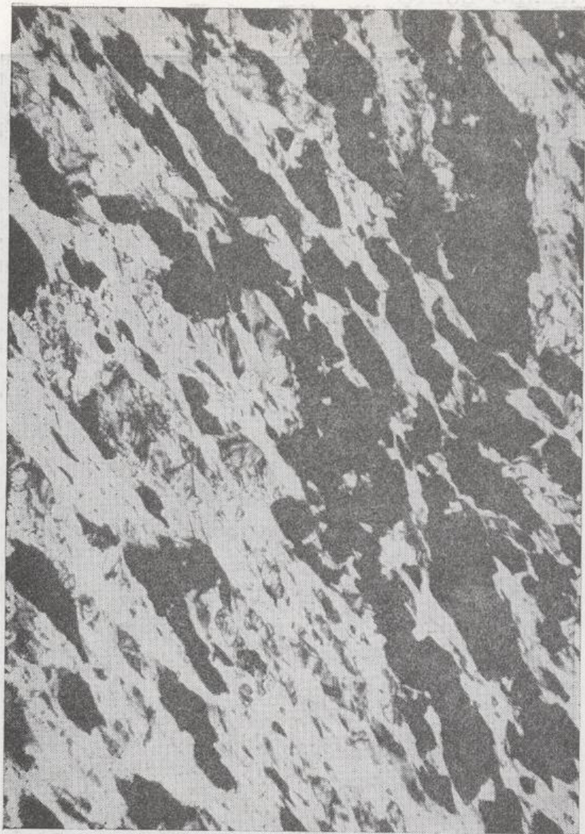
Microfot. 11.--T-1, 96 00 m. Magnetita concordante con clorita, siguiendo planos de esquistosidad. Nícoles cruzados, 135 \times .
