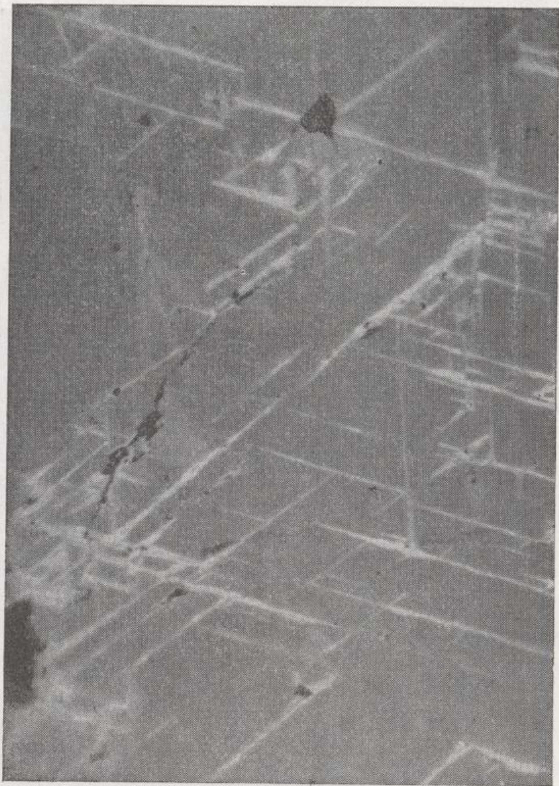
Fig. 16.—CO-1, 39,40 m. Martitización de la magnetita I. Probeta pulida, 650 \times .
