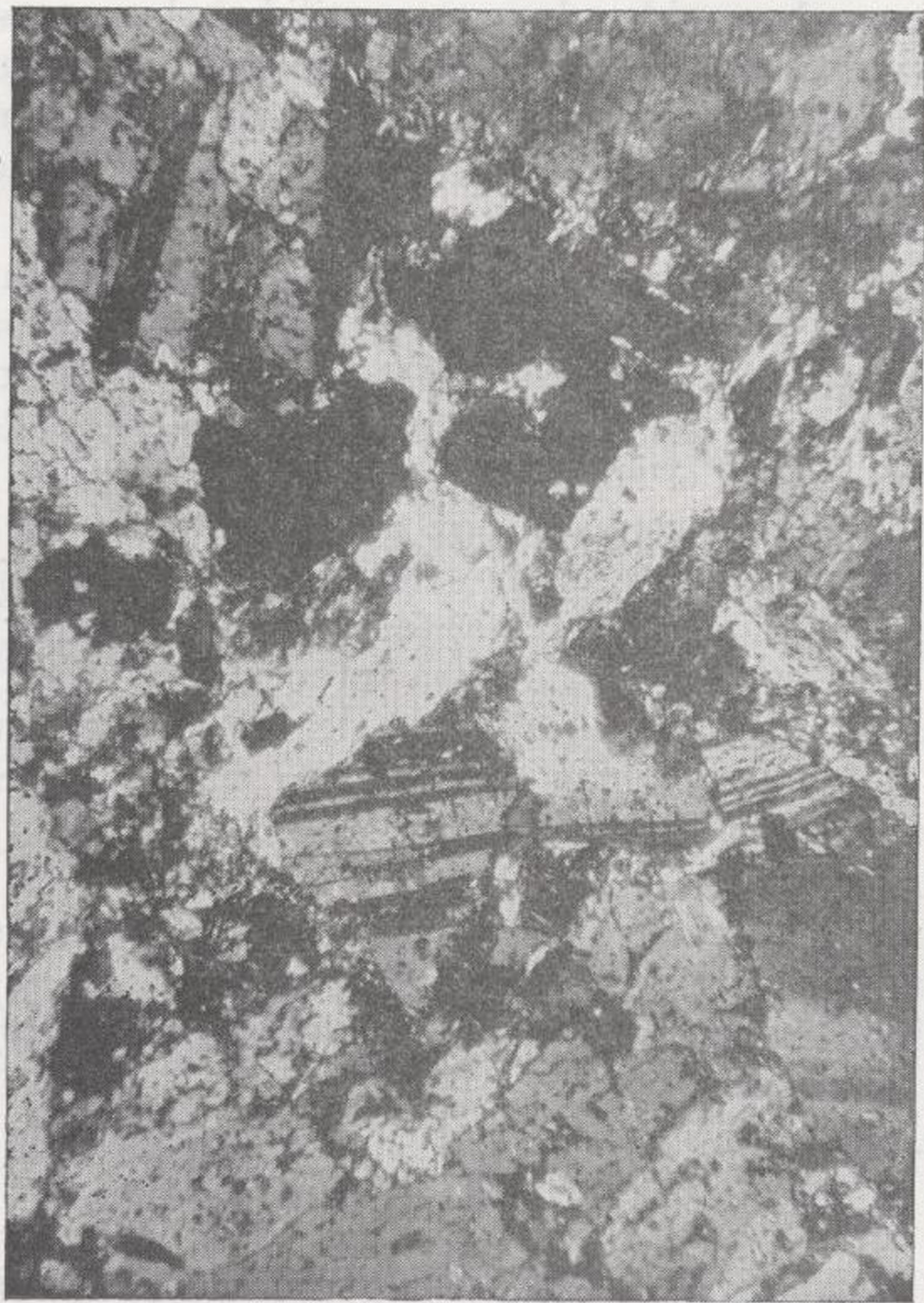
Microfot. 1.—T-1, 11,20 m. Diorita con intenso proceso de asimilación, mostrando plagioclasa, anfíbol, leucoxeno y epidota. Nícoles cruzados, 43 x.
