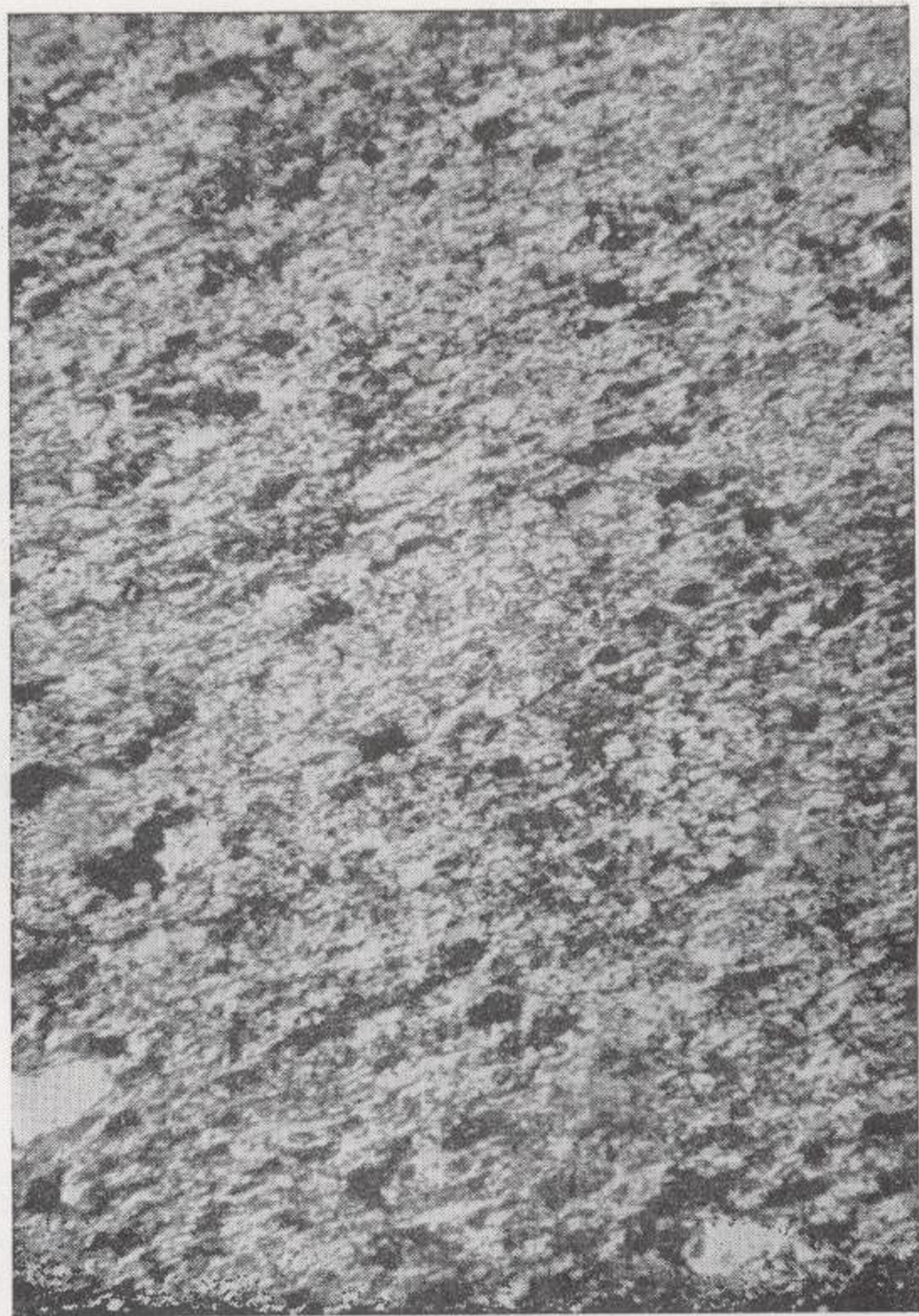
Microfot. 9.—T-1, 159,62 m. Pizarra sericítica, con cuarzo, sericita y magnetita, mostrando una textura pizarreña. Nícoles cruzados, 135 \times .
